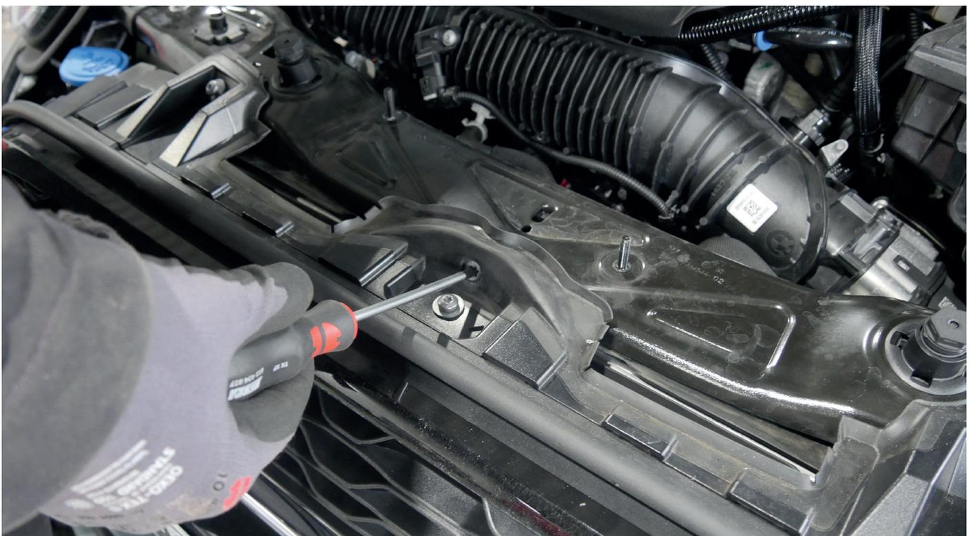
4. Schieben Sie nun das Luftblech zwischen Frontverstärkung und Schlossträger und befestigen Sie dies mit der zuvor entfernten Schraube. Richten Sie das Blech gerade aus und ziehen die Schraube fest an.
