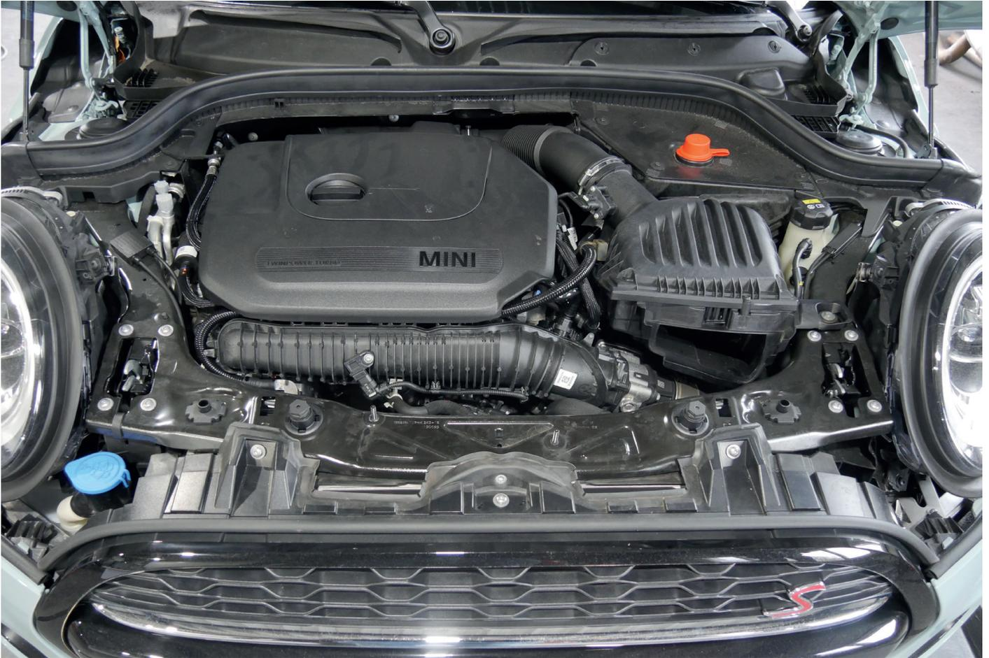
3. Lösen und entfernen Sie die T40 Schraube in der Mitte des Schlossträgers.
