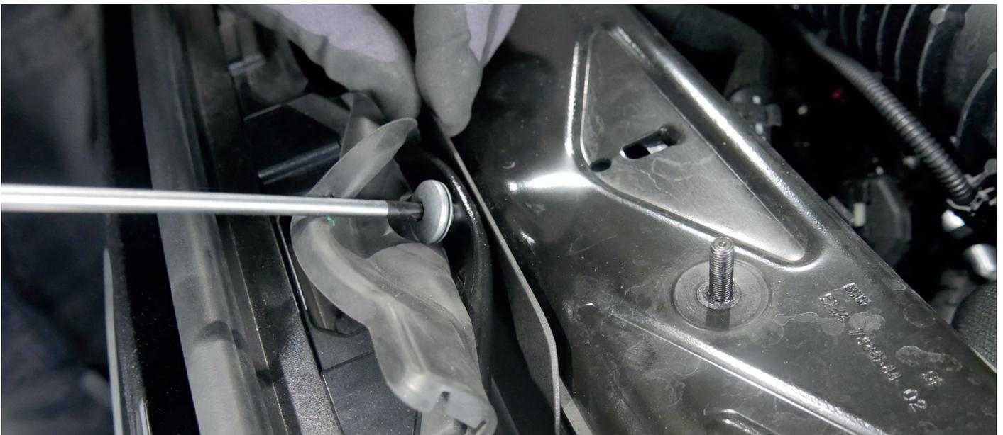
5. Montieren Sie den Luftsammler und befestigen Sie diesen mit den zuvor entfernten Schrauben.
